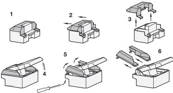
Vor der Montage müssen die Abdeckungen des Fallenverschlusses gemäß der Skizze demontiert werden. Zur Befestigung können z. B. Zylinderschrauben DIN 912, Sechskantschrauben DIN 933 sowie Sechskantmuttern ISO 4032 jeweils in der Gewindegröße M 6 verwendet werden.
